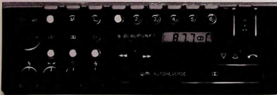
Bild 4. Zu den modernen Digital-Autoradios von Blaupunkt gehört auch der Bamberg SQR 82; in der rechten oberen Ecke die neugestaltete Doppeltaste für den Sendersuchlauf
