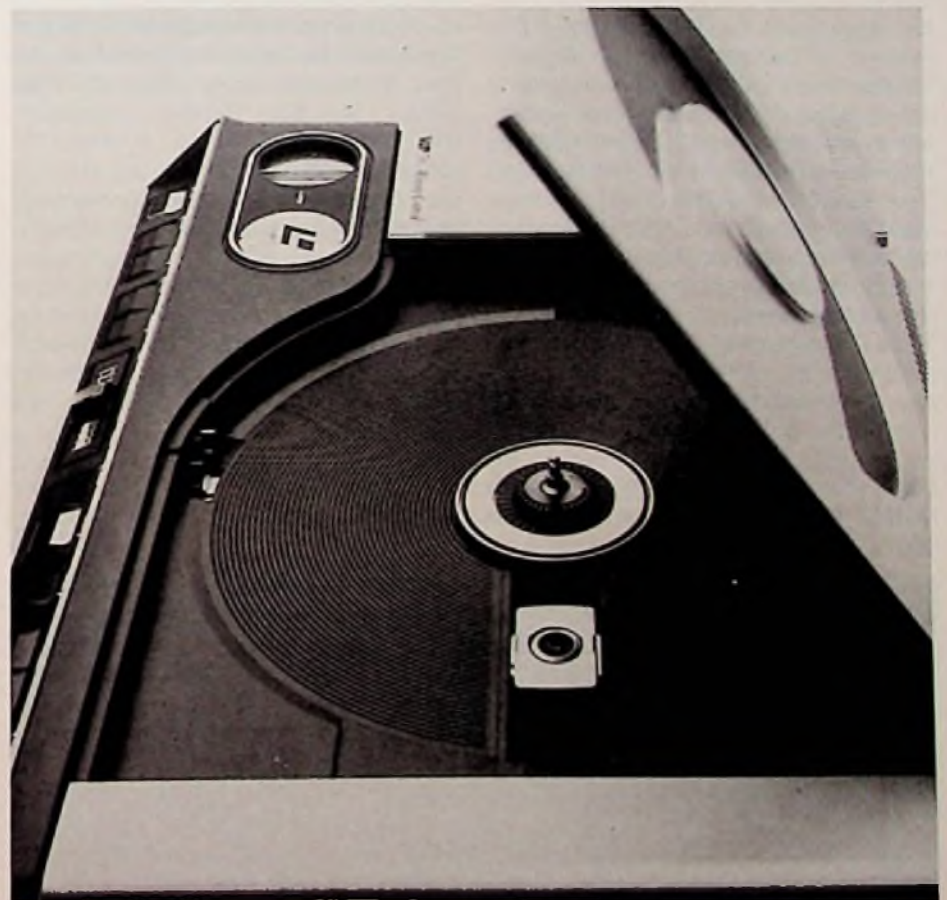
Bild 3. Der Blick in den geöffneten Spieler für LV-Videoplatten zeigt, daß diese Platten ganz normal wie Schallplatten aufgelegt werden können, im Bild vorn der von unten wirkende optoelektronische Abtaster (Philips-Bild)
