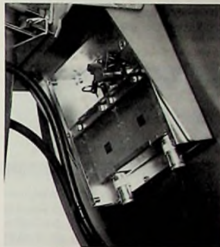
Bild 7. Hinter einem Parabolspiegel montierte Außenbaugruppe. Sie setzt das 12-GHz-Band in die 1. ZF um. Über Kabel wird das ZF-Signal ins Haus geleitet. Außenbaugruppen könnten auch unmittelbar am Empfangsstrahler im Brennpunkt des Parabolspiegels montiert sein (Zimmermann/Hans Kolbe & Co.)
