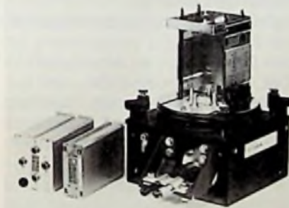
Bild 1. Haubenmuffe für den optischen Zwischenregenerator (Foto: AEG-Telefunken)
