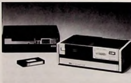
Bild 1: Verfahren Nr. 1: Zusätzlich zum herkömmlichen Video-Recorder wird ein PCM-Adapter angeschafft, der die A/D- und D/A-Wandlung übernimmt. Das PCM-Signal wird vom Video-Recorder als Pseudo-Video-Signal gespeichert (Akai)
