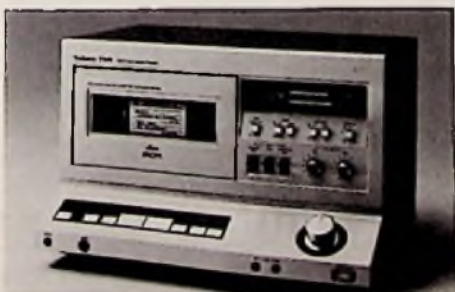
Bild 2: Verfahren Nr. 2: PCM-Digitalrecorder sind für PCM-Betrieb umgerüstete Video-Recorder mit üblichen Video-Cassetten. Vorteil: Einfache Bedienung, wenig Platzbedarf. Nachteil: Keine Video-Aufzeichnung möglich (Technics)
