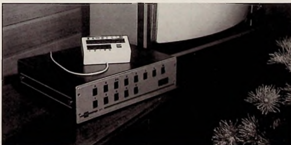
Bild 9. Prototyp einer Innenbaugruppe für Satelliten-Direktempfang. Jeder Teilnehmer einer Einzel-Antennenanlage muß sich zum Individualempfang so eine Innenbaugruppe anschaffen. Am Bedienfeld wird der Satellit und das gewünschte Programm ausgewählt. Die Innenbaugruppe bereitet den betreffenden Kanal dann so auf, daß ein Fernsehempfänger auch unmittelbar (AV-Buchse) angeschlossen werden kann (Zimmermann/Hans Kolbe & Co.)
