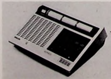
Bild 1. Moderne Gegensprechanlage für einige hundert Teilnehmer (Philips-Pressbild)
