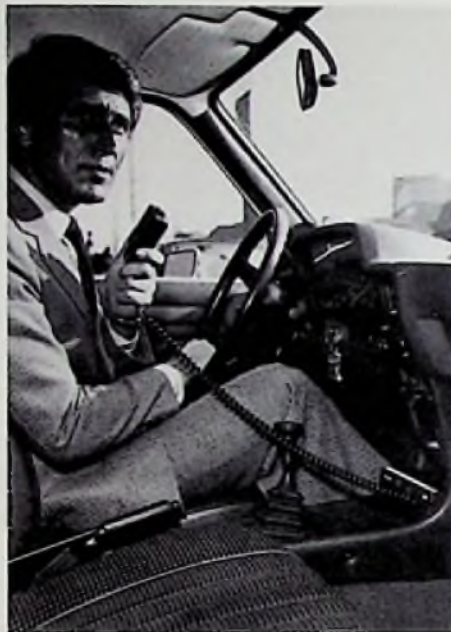
Bild 6. Die Bedienelemente der Sprechfunkanlage sind im Handmikrofon integriert (Werkfoto TE KA DE)
