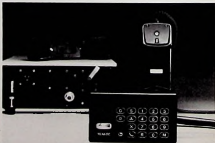
Bild 7. Autotelefon BSA 31 mit Send/Empfangsanlage, Bedienteil und Hörer (Werkfoto TE KA DE)
