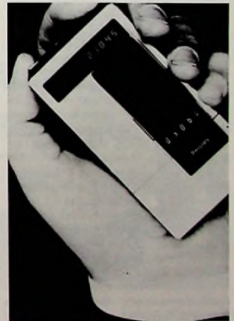
Bild 4. Empfänger einer digitalen Personensuchanlage (Philips-Presebild)
