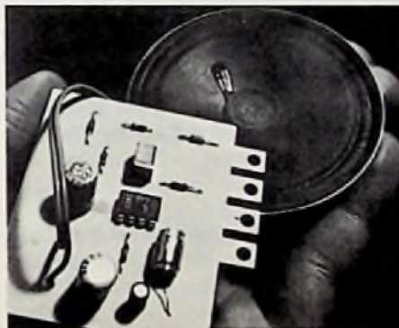
Bild 6. Praktische Ausführung eines Ein- und Mehrklang-Gongs (Siemens-Pressebild).
