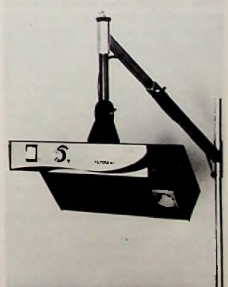
Bild 1. Lötdampfabsorber mit Aktivkohlefilter (Foto: Polytechnik)
