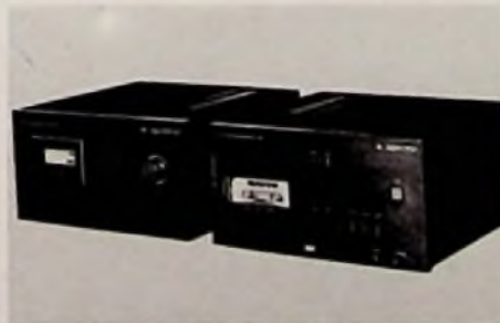
Bild 4: Verfahren Nr. 4: Ebenfalls mit feststehendem Kopf arbeitet dieser PCM-Cassettenrecorder. Er verwendet ein Elcaset-Laufwerk (9,5 cm/s Bandgeschwindigkeit). Die Elektronik ist aber noch so aufwendig, daß keine Serienfertigung erfolgt (Sanyo)
