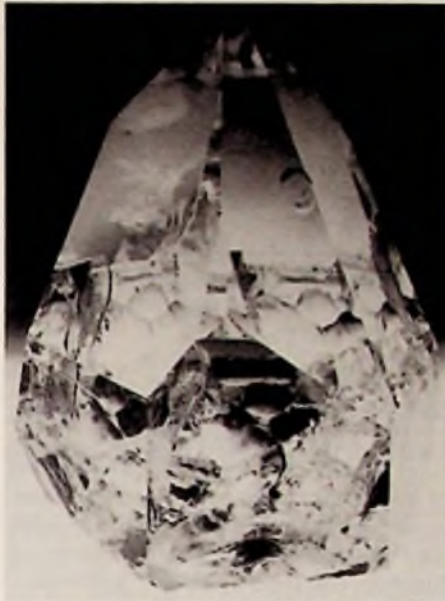
Bild 2: a) (links) Fotografie eines auf hydrothermale Weise hergestellten Quarzkristalls. b) Zeichnung eines Kristalls in ungefähr derselben Position, mit den Kristallachsen x, y und z.
