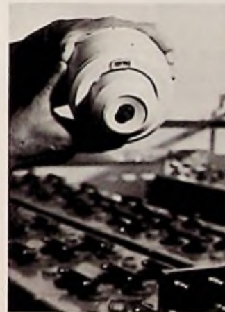
Bild 1: Neuer Gassensor auf Halbleiterbasis (Siemens-Pressbild)
