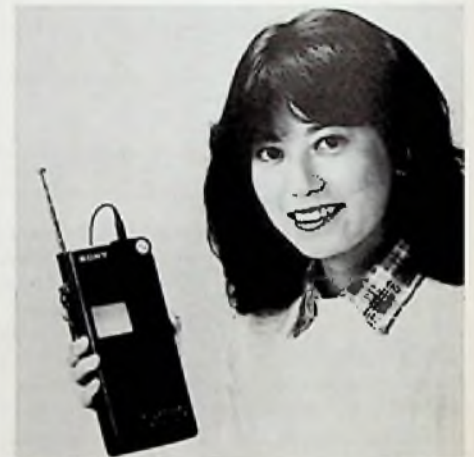
Bild 2: Der Taschenteleferseher mit Flachbildröhre braucht nur 1,8 W (Sony-Pressbild)
