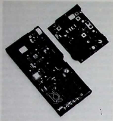
Bild 7: Das Innere des Eurosignal E 300 von SEL.
