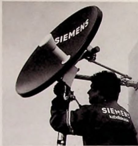
Bild 7: Prototyp einer Heimempfängsanlage für das 12-GHz-Satellitenfernsehen
