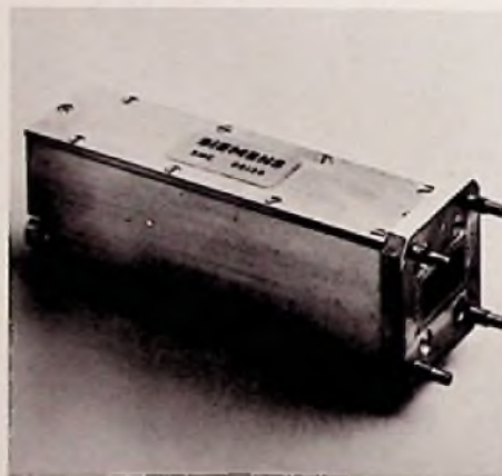
Bild 8: Vollständiges Umsetzermodule mit Vorverstärker, Mischstufe und ZF-Verstärker
