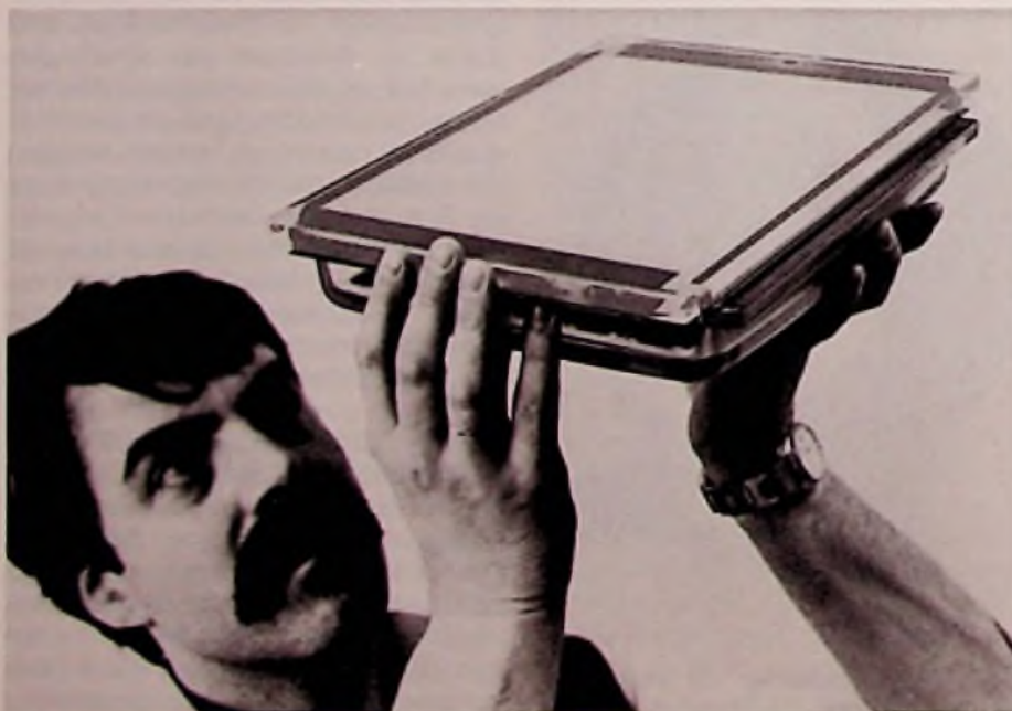
Bild 2: Flachbildröhre von 6 cm Dicke mit 36 cm Diagonale (Siemens)
