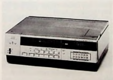
Bild 3: Der erste Helmvideo-VHS-Recorder (HR-7600) für einen elektronischen Assemble- und Insert-Schnitt
