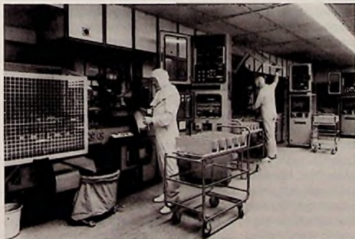
Bild 1: Fertigung von Compact Disc bei Polygram auf Spritzpressen unter Reinluft-Bedingungen
