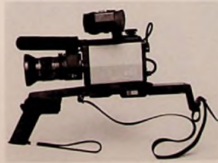
Bild 1: Röhrenlose Videokamera mit Halbleiter-Bildwandler und semiprofessioneller Ausstattung (Hitachi-Pressbild)
