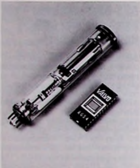
Bild 1: Größenvergleich zwischen 1/8"-Vidikon und RGS-Bildaufnehmer Valvo-Pressbild
