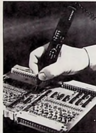
Bild 1: Prüfstift für Digital-Schaltungen in der Anwendung (Siemens-Pressbild)
