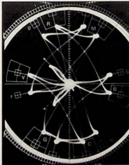
Bild 10: Kontrolle der Farbqualität (Farbart, Sättigung u. Phase) an einem Vektorskop mit dem Farbbalken-Signal des VG-1000 (hier: Farbton korrekt; Farben etwas entsättigt)
