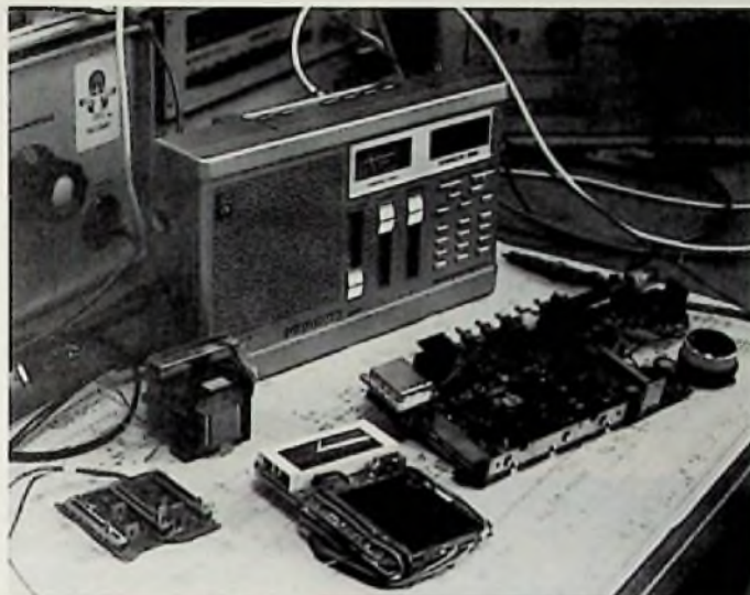
Bild 1: Der Satellit 300 und seine wesentlichen Baugruppen (v. l. n. r.): Lautstärke-/Klangeinsteller, Netzteil, Eingabetastatur mit Uhren-/Frequenz-Display und Mikrocomputer, Empfangs- und Verstärker-teil sowie der „Handabstimmknopf“ (Inkrementengeber) (Grundig-Pressfoto)
