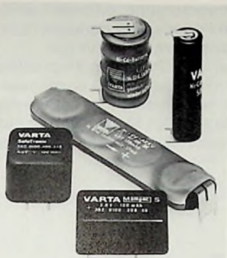
Bild 5: NiCd-Akkumulatoren werden in der Digital-Technik zum Bauelement und sichern gegen Netzstörungen
