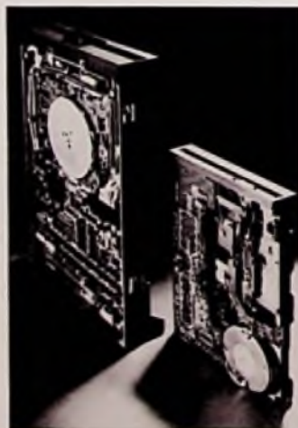
Bild 1: Flache Floppy-Disk-Laufwerke (links Typ 6105, rechts 6138) (Feltron-Pressbild)
