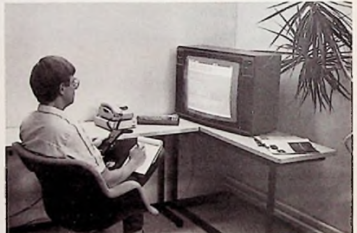
Bild 6: Bildschirmdialoggerät für den CEPT- als auch den Prestelstandard (Salora-Pressebild)
