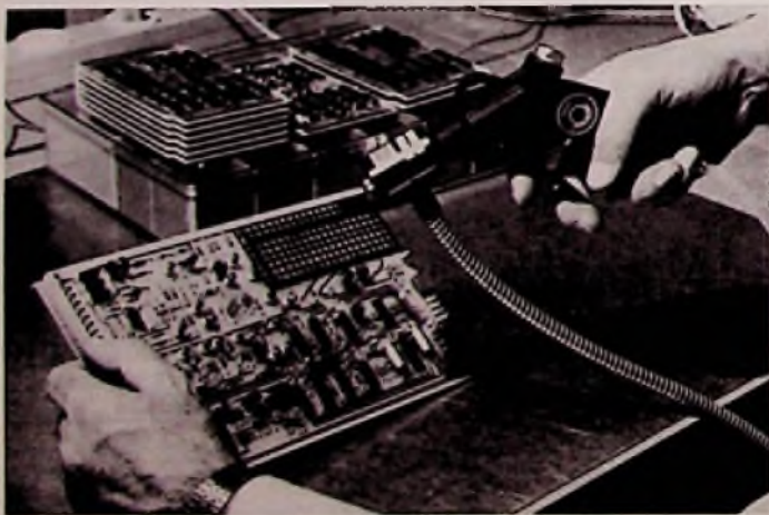
Bild 1: Anwendung des Haug-Ionen-Generators bei der Platinen-Bestückung in einem Elektronik-Betrieb. (Haug-Pressfoto)
