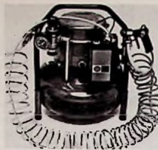
Bild 2: Der Haug-Ionen-Generator mit Kompressor: eine mobile Kompaktanlage zur Beseitigung von Staub und elektrostatischen Aufladungen in einem Arbeitsgang. (Haug-Pressfoto)
