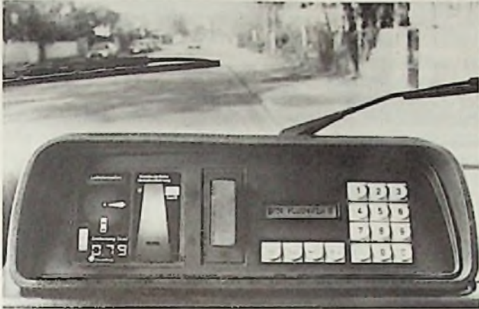
Bild 1: Autofahrer Lotsensystem „Auto-Scout“ im Armaturenbrett eines VW-Busses (Siemens-Pressbild)
