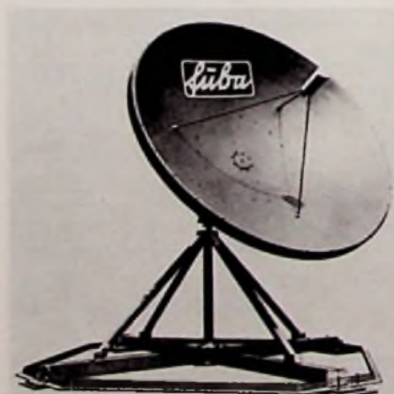
Bild 11: Die fuba-SEA 300 Parabolantenne mit 3 m Durchmesser zum Empfang schwacher Satellitensignale im 12-GHz-Bereich, die seit 1978 zu Versuchszwecken u. a. zum Empfang der OTS-2-Signale eingesetzt wird (fuba-Pressbild)
