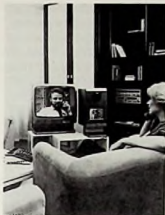
Bild 1: Breitbandige integrierte Glasfaser-Orts-Netze (BIGFON) erlauben nicht nur Bildfernsprechen, sondern viele weitere Kommunikationsdienste (PKI/TEKADE-Pressbild)
