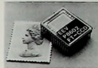
Bild 1: CCD-Bildsensor mit geringen Abmessungen (Nucletron-Pressbild)
