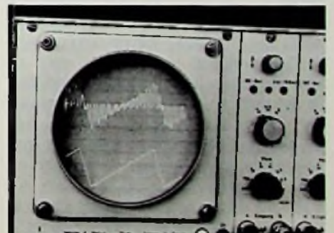
Bild 10: Signale nach der Demodulation; a) Sinus; b) Sägezahn
