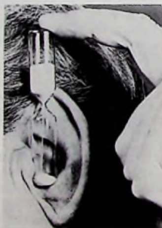
Bild 1: Keine Sanduhr sondern ein Hörtester ist dieses Glasröhrchen (Sennheiser-Pressbild)
