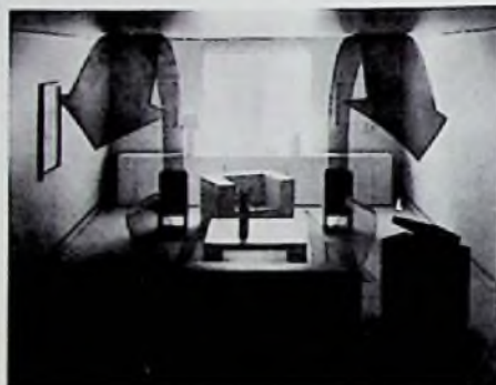
Bild 2: Wirkungsweise der Wohnraum-HiFi-Box PP8. Dem nach vorn abgestrahlten Direktschall folgt zeitlich verzögert der indirekte Schall, der nach oben abgestrahlt und von Wänden und Decke reflektiert wird
