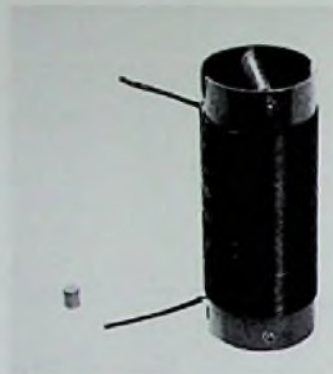
Bild 1: Größenvergleich der Vogt-Hochfrequenzspule von 1933 mit einer bis dahin üblichen Luftspule (Vogt-Pressbild)
