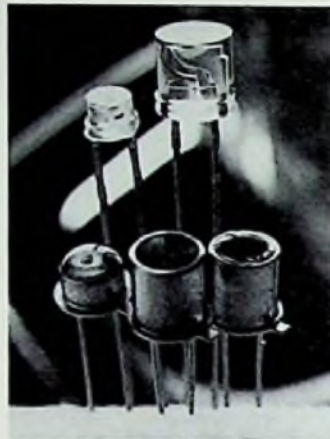
Bild 1: Infrarot-Sendedioden hoher Lichtstärke (Siemens-Pressbild)
