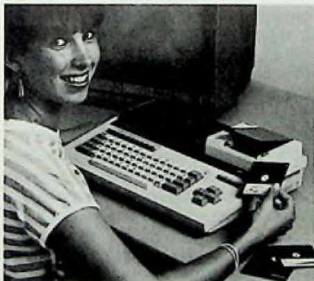
Bild 7: Den bewährten MZ-700 gibt es jetzt auch mit eingebautem Mini-Floppy-Laufwerk (2,8", 2 x 64 KByte). Das Speichern des RAM-Inhalts (64 KByte) dauert 8 Sekunden (Sharp-Presebild)
