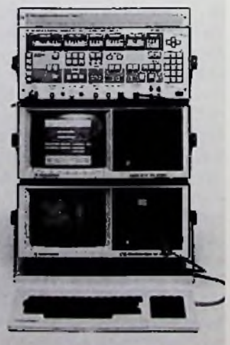
Bild 1: Moderner Meßplatz für Sprechfunkgeräte (Rohde & Schwarz-Pressbild)
