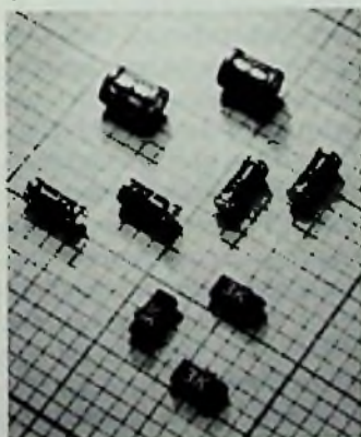
Bild 1: Neue Gehäuseformen für die Oberflächenmontage (Intermetall-Pressbild)
