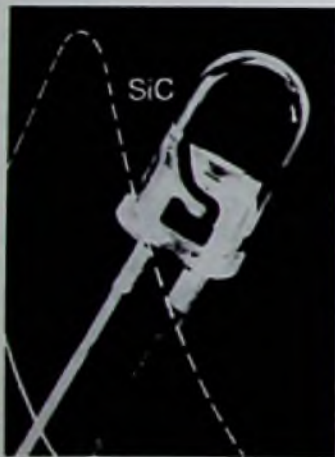
Bild 1: LED aus Siliziumkarbid mit blauem Licht
