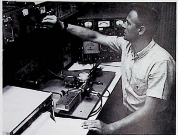
Bild 1: Eichung eines Hohlleiter-Rauschgenerators für 12,4 bis 18 GHz (AEG-Telefunken-Pressbild)
