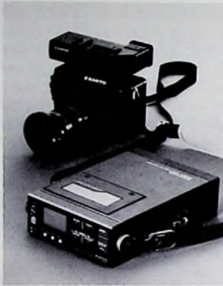
Bild 6. Das 8-mm-Videosystem von Sanyo. Oben die Videokamera mit dem darauf befindlichen Suchermonitor; darunter der tragbare 8 mm-Recorder (Sanyo-Pressbild)
