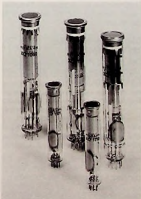
Bild 1: Das Vidikon ist vom Plumbicon äußerlich kaum zu unterscheiden. Hintere Reihe 1 inch- und vordere Reihe ½ inch-Typen. Inzwischen sind auch ½ inch-Typen verfügbar (Heimann-Pressbild)
