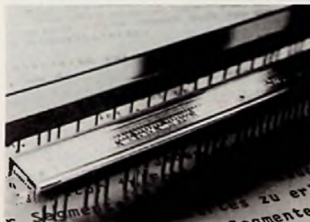
Bild 5: LED-Balkenanzeige mit 101 Segmenten (Siemens-Pressbild)
