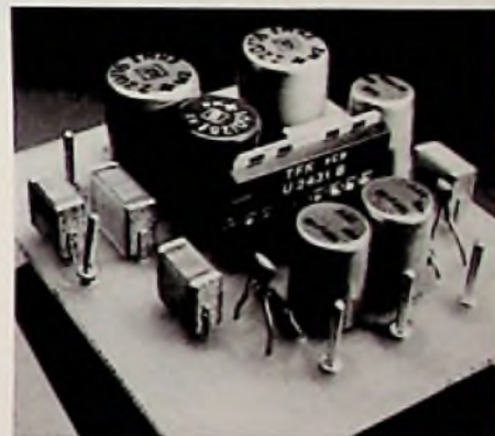
Bild 7: Integrierte Schaltung mit ihren Peripherie-Elementen für einen Stereo-Verstärker mit 1 W je Kanal (Telefunken-electronic-Pressbild)
