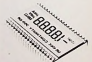
Bild 1: Entspiegelte LCD-Anzeige (Hitachi-Pressbild)
