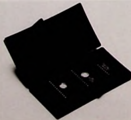
Bild 11: Besonders Mos-ICs sollten in leitfähigem Schaumstoff verpackt werden (3 M-Pressbild)
