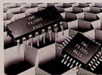
Bild 1: Einchip-LSI-Filter in Keramik-DIL- und in Kunststoff-Flatpackgehäuse (Ginsbury-Pressbild)
