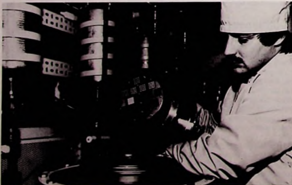
Bild 1: Herstellung von amorphem Silizium in dem Moment, wo der bestückte Substrathalter in die Plasma-Depositionsanlage eingesetzt wird. Nach einer Depositionszeit von 30 Minuten ist eine 0,5 µm dicke Siliziumschicht aufgebracht (AEG-Telefunken-Pressbild)
