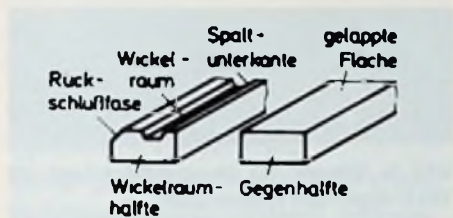
Bild 3b: Ausfräsen der Videospurbreiten und Wickelräume
