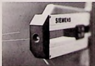
Bild 1: In 40 s ist die Beschichtung der Glasfaser abgesetzt (Siemens-Pressbild)
