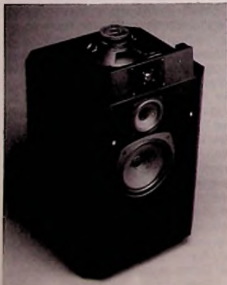
Bild 5: Die Push Pull-Technik der Agora B. Der zweite, nach oben strahlende Tieftöner arbeitet mit entgegengesetzter Membranauslenkung (Revox-Pressbild)
