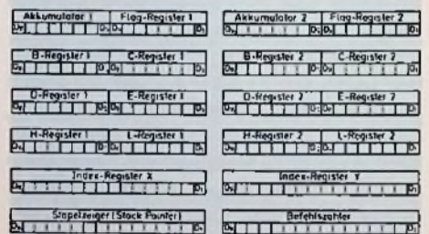
Bild 4.7.7: Innere Registerstruktur des Mikroprozessors Z 80
