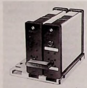
Bild 1: Neue ZF-Umsetzer für Gemeinschafts-Antennenanlagen (Hirschmann-Pressbild)
