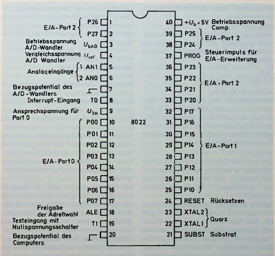
Bild 4.7.10: Gehäuseanschlüsse des Mikrocomputers 8022
