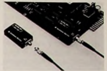
Bild 1: Optronische Sendeelemente und Empfängermodule für maximal 200 Mbit/s (ITT-Presebild)
