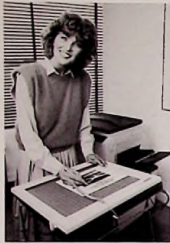
Bild 1: Markierte Stellen einer Vorlage werden herauskopiert, vergrößert oder verkleinert, ohne daß die Vorlage beschädigt werden muß
