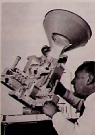
Bild 1: Mit der Systemweiche können zwei Richtfunk-Frequenzbereiche jeweils doppelt polarisiert auf eine Antenne konzentriert werden (Siemens-Pressbild)
