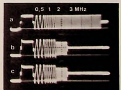
Bild 2: Video-Übertragungsbereich a) Multi-burst 0,5–4,8 MHz vor Band. b) über Band bei v_0 . c) über Band bei 0,5v_0
