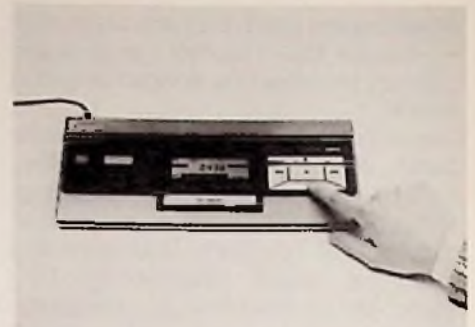
Bild 7: Vorprogrammierbare Schnittsteuer-einheit für bildgenaues Überspielen zwischen V-8 und 1/2"-Recordern (Sony-Pressbild)
