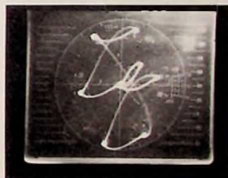
Bild 3a: Vektorbild am AV-Ausgang eines optimal abgeglichenen Farbfernsehers (Vergleiche mit Bild 2b)
