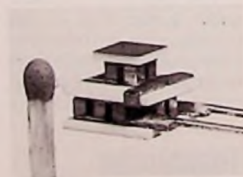
Bild 1: Peltier-Kühler zur elektronischen Kühlung von Halbleiterbauelementen (Nucletron-Pressbild)
