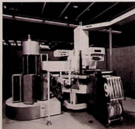
Bild 2: Softwaregesteuerter Bestückungsautomat für die SMD-Technologie (Philips-Elcoma-Pressbild)
