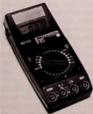
Bild 1: Digitales Handmultimeter für alle Zwecke (Zeheter-Pressebild)
