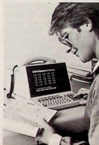
Bild 1: Als Multitel zugelassenes Bildschirmtext-Telefon (Siemens-Pressbild)
