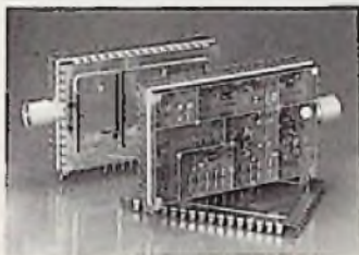
Bild 1: Universal-Fernsehtuner in SMD-Technologie (Valvo-Pressbild)
