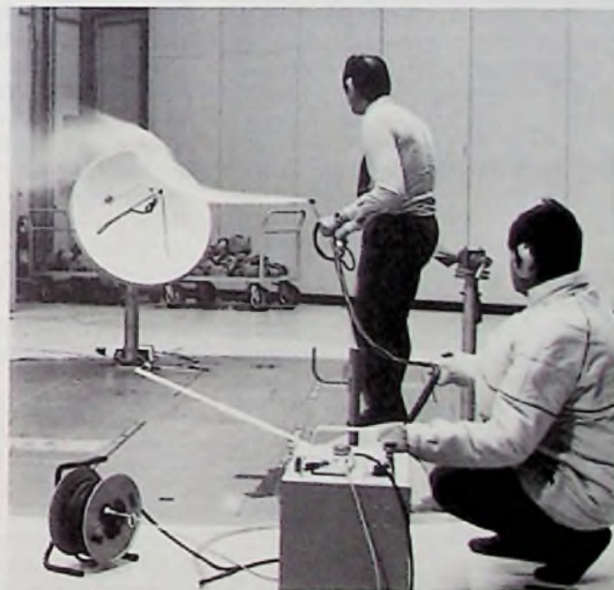
Bild 1: Prüfung einer Parabolantenne mit Hitze, Kälte und Wind bei den Fordwerken in Köln (Bayer-Pressbild)
