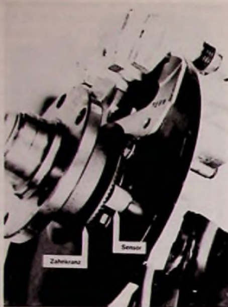
Bild 4: Sensor am Hinterrad als Signalgeber für das Eva-System (Blaupunkt-Pressbild)
