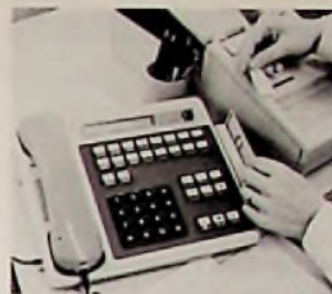
Bild 1: Dialogfähiges Magnetkartentelefon Makatel liest Kreditkarten und meldet Akzeptanz (Siemens-Pressbild)
