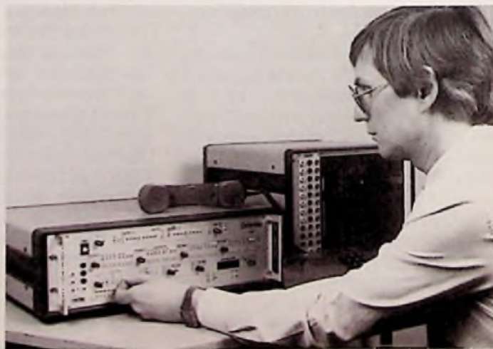
Bild 16: Schnittstellensimulator für EWSD-Baugruppen (DeTeWe-Pressbild)
