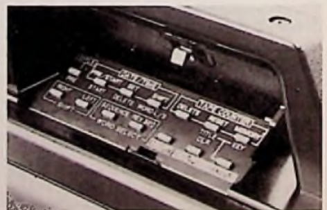
Bild 8: Aufklappbares Bedienfeld für Titel- und Zeitgenerator
