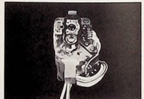
Bild 2b: Optischer Abtaster aus eigener Entwicklung (Thomson-Brandt-Presebild)
