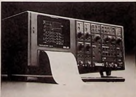
Bild 6: Digitales Speicher-Oszilloskop SE 571 (BBC-Goerz/Metrawatt-Pressbild)
