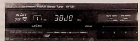
Bild 8: Anzeige der vollzogenen optimalen Abstimmung (quartz lock), der gewählten ZF-Bandbreite (normal), des Eingangsspegels (dB) und die LED-Quittungen (Stereo/Signal-Fidelity) im Stationsmonitor
