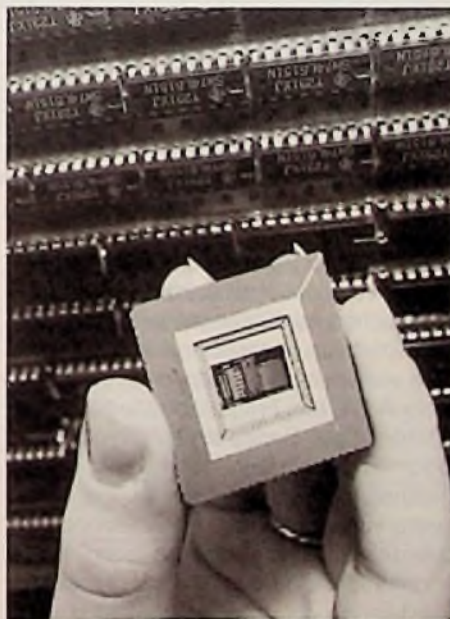
Bild 1: 16-bit-Signal-Prozessor für 3 Mio. Multiplikationen pro Sekunde (AEG-Pressbild)
