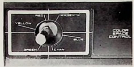
Bild 4: Mit dem „Color Space Control“ bezeichneten Rundum-Steller lassen sich durch geradlinige oder kreisende Bewegungen beliebige Farbtöne einstellen
