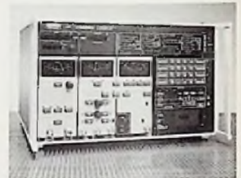
Bild 1: Ausbaufähiger Funkgerätemeßplatz (Schlumberger-Pressbild)
