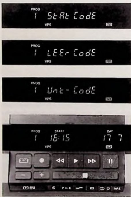
Bild 1: Anzeige des VPS-Codes (oberer Teil) oder des VPS-Labels der laufenden Sendung (ITT-Pressbild)
