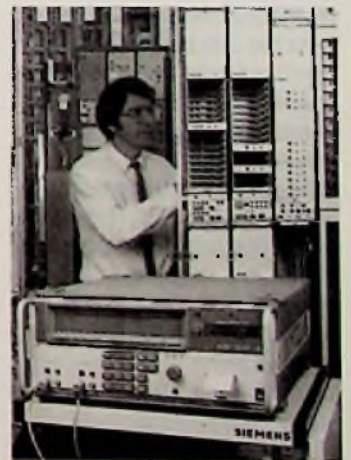
Bild 1: Bitfehlermeßgerät für pulscodemodierte Übertragungstrecken (Siemens-Pressbild)
