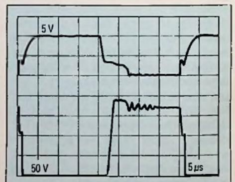
**Bild 9: Durch Einsatz der dynamischen Klemmschaltung wird der 200-V-Spannungssprung nach Bild 8 auf  $<190$  V geklemmt**
