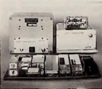
**Bild 1:** Im Vordergrund der Video-Empfänger in flacher Bauweise, im Hintergrund links ein Videosender, rechts ein solcher in Einschubtechnik, darüber die geöffnete Senderendstufe in Stripline-Technik
