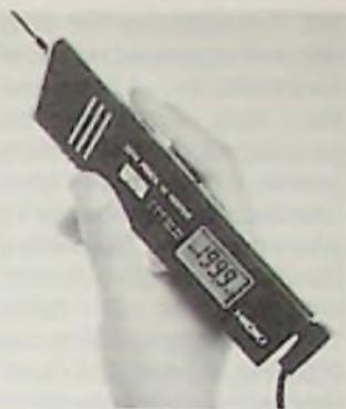
Bild 1: Digitalmultimeter für die Jackentasche (Brenner-Pressbild)
