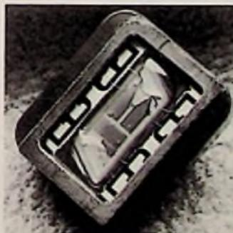
Bild 1: Blick in das Innere eines Oberflächenwellen-Filters (Siemens-Pressbild)
