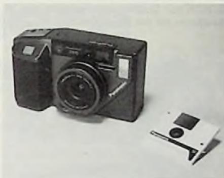
objektiv 1:1,7/10 mm und ein Teleobjektiv 1:4/25 mm, das entspricht einer Brennweite von 40 mm und 100 mm bei Kleinbildfoto. Verschlusszeiten 1/250 s bis 1/30 s; Leuchtrahmensucher; Infrarot-Autofocussystem; TTL-Belichtungsmessung; eingebauten Elektronenblitz, Leitzahl 15; CCD-Bildwandler mit 300 000 Bildpunkten (Pixels); die Bildauflösung ist angegeben mit horizontal 350 Zeilen und vertikal mit mehr als 400 Zeilen; die Empfindlichkeit der Kamera entspricht ISO
