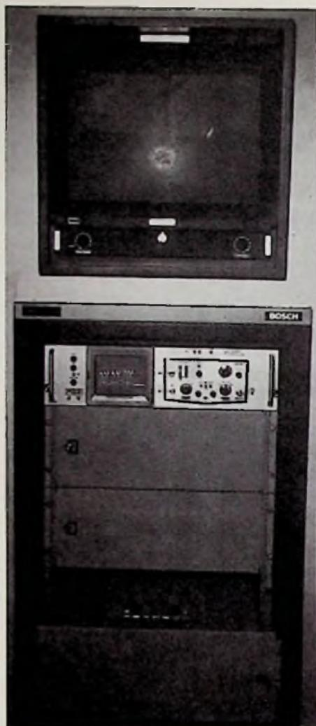
**Bild 5:** Bosch – jetzt BTS – lieferte für Forschungsinstitute die ersten HDTV-Kameras. Sie arbeiten entweder im 125/60- oder 1249/50-„Standard“ (umbaubar). Das Bild zeigt die zugehörige Kamerakontrolleinheit (Foto: R. Bücken)
