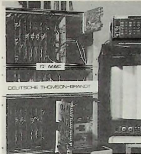
**Bild 1: D2-MAC-Decoder im Labor der Deutschen Thomson-Brandt: Jetzt gibt es von Intermetall die Schaltung „auf Silizium“**
