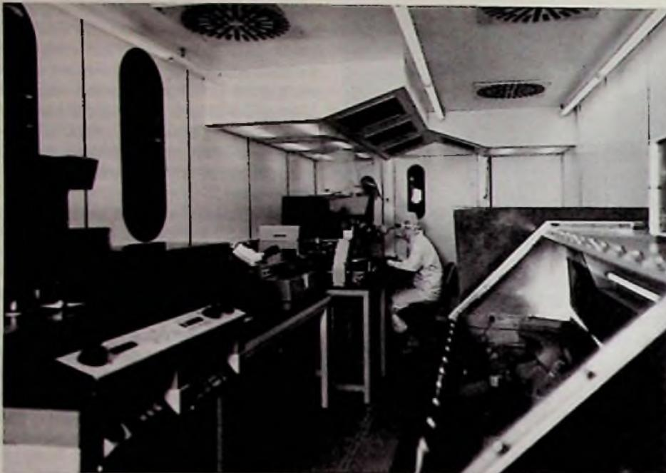
**Bild 4:** In den Reinnräumen der Container-Fabrik des Lasarray-Systems können pro Tag mehr als 1000 Gate Arrays bei einer Ausbeute von 35% hergestellt werden
