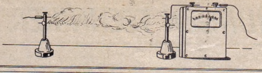
Durch Erhitzung des Drahtes verbrennt die Umspinnung
