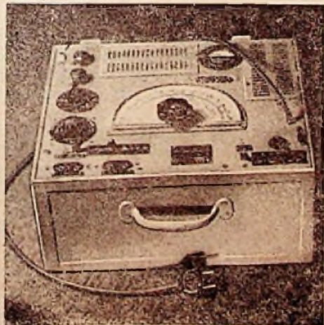
„Elnug“-Drahtfunk-Meßkoffer zur Überwachung und Kontrolle hoch- und niederfrequenter Drahtfunknetze. Rechts: Netzteil und Meßteile sind durch Abschirmungen sorgfältig voneinander getrennt. Links: Hochfrequenz-Generator (C. Lorenz) für industrielle Zwecke (Wärmedurchflutung im Kondensatorfeld)
