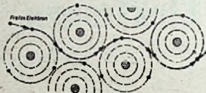
Abb. 5. Darstellung des Leitungsvorganges (Gleichstrom) in Aluminium
