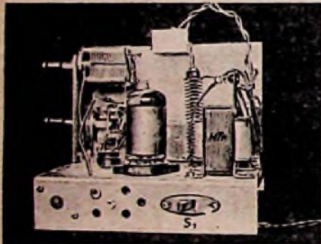
Abb. 4. Rückansicht des Empfängerchassis. Die Hartpapierplatte mit dem Spulensatz und dem Rückkopplungsdifferentialdrehkondensator sowie der Trockengleichrichter sind deutlich zu sehen
