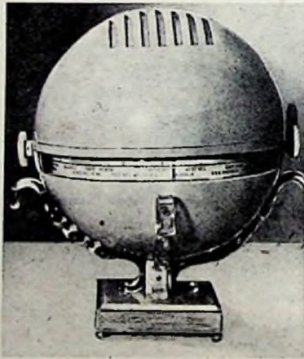
Fünf-Röhren-Super „Venus“ der Firma Champion in Seaford. Das Gerät ist in Globusform gebaut; der nach oben strahlende Lautsprecher ermöglicht eine verzerrungsfreie Wiedergabe. Aufnahme (A.P.) Illus
