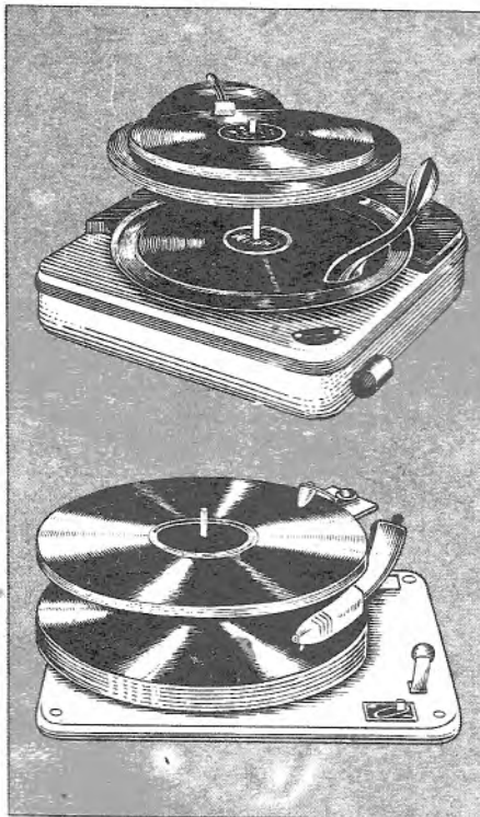
Abb. 8 (oben): Modernster amerikanischer Plattenspieler mit leichtem Kristall-Pick-up. Plattenwechselzeit nur 3 1/2 Sekunden („Silent Speed Record Changer“ der Zenith Radio Corp. Chicago, Ill. Abb. 9 (unten): Der Detrola-Plattenspieler, ein billiges USA-Modell
