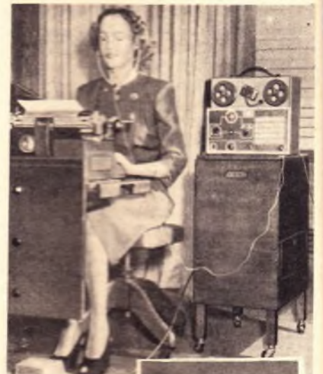
Diktiermaschine angeschlossen werden. Zur Steuerung der Anlage dient ein Fußschalter.
