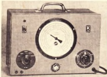
Abb. 1. Handlicher Meßsender von K. Gabler, Glarus/Schweiz, bei dem die wenigen Bedienungsknöpfe auffallen
