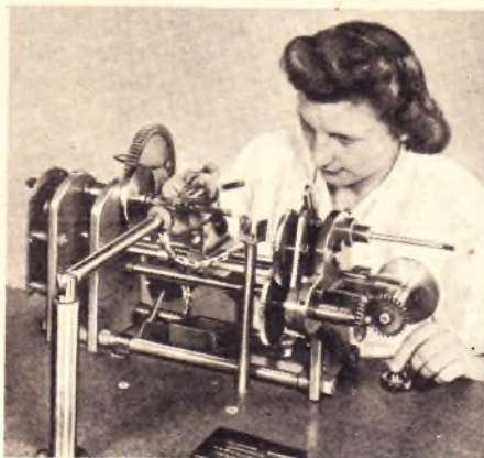
Abb. 1. Doppelwandel-Maschine zur Herstellung des Heizdrahtes
