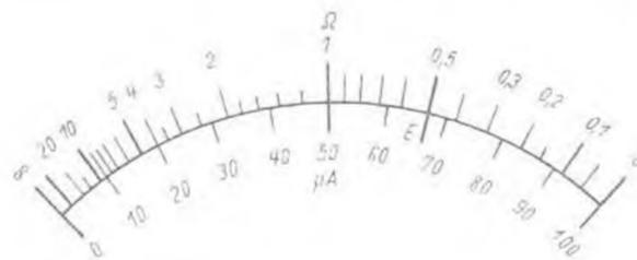
Abb. 4. Umgekehrte Skala für Widerstandsmessung
