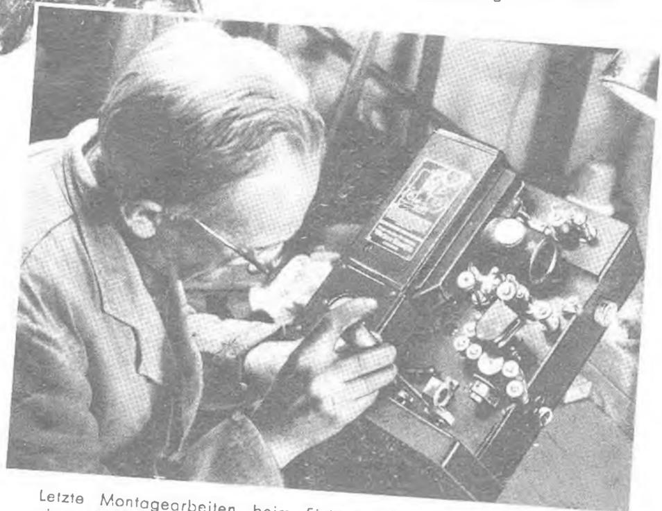
Letzte Montagearbeiten beim Einbau eines Lichttongerätes an einem Projektor. Unten: Schaltarbeiten an einem Hauptverstärker
