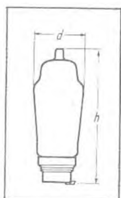
Röhrenabmessungen h max. 130 mm d max. 45,5 mm
