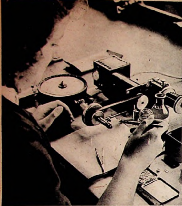
Das Wickeln der nur 1 mm dicken Spulen erfordert äußerste Sorgfalt, hohe Geschwindigkeit und große Feinfühligkeit der Facharbeiterinnen
