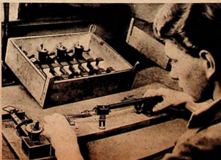
Unten: Das Richten der Haltefeder und genaues Auswiegen des Auflagedruckes. Dieser beträgt beim Tonarm TO 1002 nur 26 Gramm
