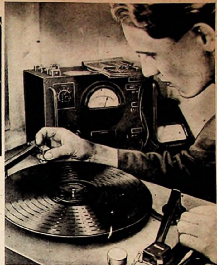
Jedes System des Telefunken-Tonabnehmers TO 1002 wird einzeln geprüft. Die Prüfung wird durch Abspielen von Frequenzplatten sowie mit Hilfe eines Schwebungssummers durchgeführt
