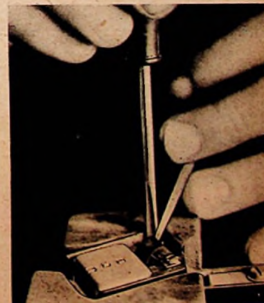
Einbau der Schutzrolle. Eine abgetlichte Rolle verhindert beim Aufsätzen eine Beschädigung des Saphirs
