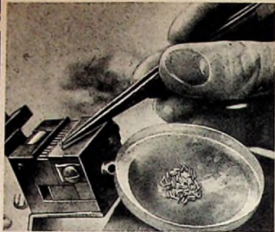
Das Einpressen der 1 mm dicken und 7 mm langen Saphirstifte in die geschlitzten Anker erfolgt mittels einer Spezialvorrichtung
