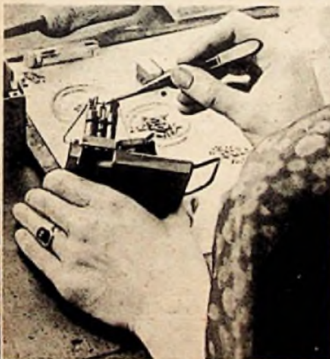
Unten: Das Richten der Haltefeder und genaues Auswiegen des Auflagedruckes. Dieser beträgt beim Tonarm TO 1002 nur 26 Gramm
