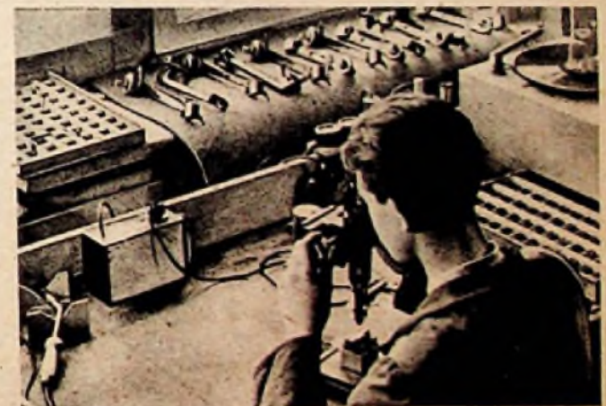
Jedes System des Telefunken-Tonabnehmers TO 1002 wird einzeln geprüft. Die Prüfung wird durch Abspielen von Frequenzplatten sowie mit Hilfe eines Schwebungssummers durchgeführt
