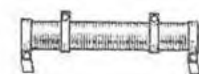
Rohrwiderstand mit keramischem Träger (z. B. aus Calit)
