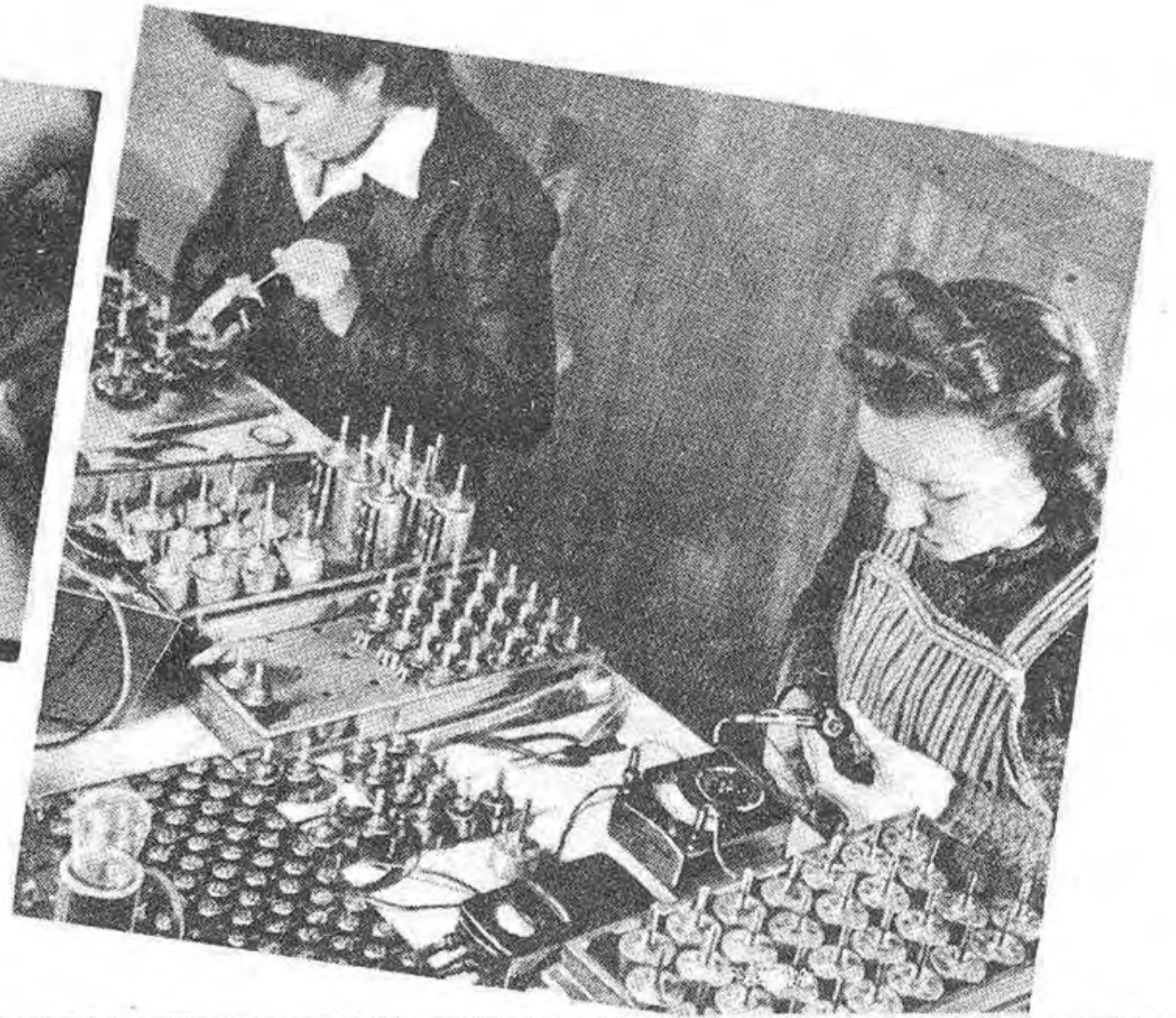
Einlegen des Widerstandstreifens im „Gnom“. Rechts: Fertigungskontrolle von Ein- u. Mehrfachpotentiometern
