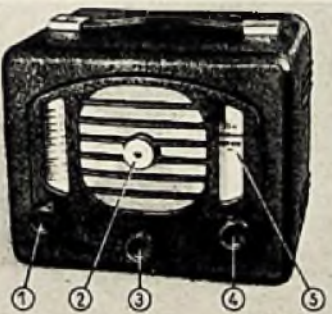
① Abstimmung, ② Beleuchtungslampe mit Drehblende, ③ Lautstärkeregl., ④ Wellenbereichschalter, ⑤ Wellenbereichsanzeige
