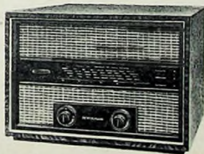
„Heinzelmann“ 168 GW, ein Einkreisler für Kurz-, Mittel- und Langwellen. — Oben: Das theoretische Schaltbild des gleichen Gerätes
