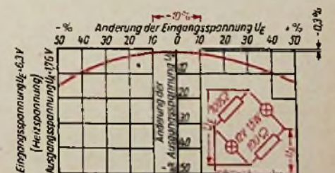
Abb. 6. Wirkungsweise der Glühlampenbrücke
