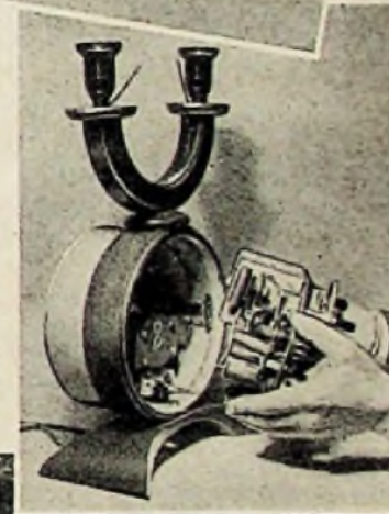
Ein Spezialempfänger für frequenzmodulierte UKW-Sendungen zwischen 2 und 8 m der Firma EWEKA, Aschheim b. München. Das Gerät gestattet auch Feldstörkemessungen
