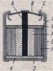
Abb. 1. Schnitt durch das Vidor-Element
