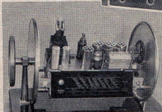
Opta „Kosmos“ mit eingebautem UKW-Zusatzgerät. Links das komplette Schallbild des Vorsatzgerätes
