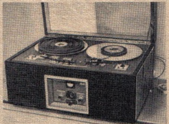
Ein Schneidgerät in Kofferform für Folien, in das ein Opta-Zwergsuper eingebaut ist. Der Motor ist für 33 ½ und 78 Umdrehungen eingerichtet. Rechts das Magnetbandgerät „Münchberg Ia“
