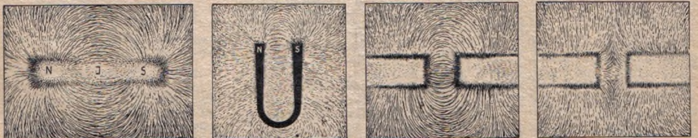
Abb. 2 (von links nach rechts). Kraftlinienverlauf eines Magnetstabes; magnet. Feldlinien eines Hufeisenmagneten, dargestellt im Eisenfeilicht; Feld zweier entgegengesetzter Magnetpole; Magnetfeld zweier gleichnamiger Pole
