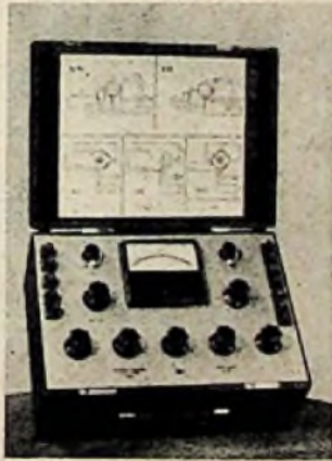
Kabelmeßgerät für Isolations-, Kapazitäts-, Leitungswiderstands- und Fehlerartmessung
