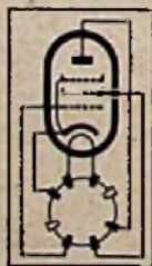
Sockelschaltung Die Anschlüsse sind von unten gesehen
