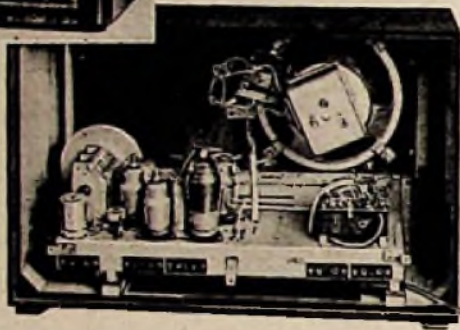
Das Innere des Siemens Symphonie ISH 598 W mit E-Röhren
