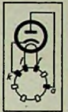
Sockelschaltung Anschlüsse von unten gesehen
