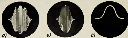
a) HF-Kurve eines überkritisch gekappten Bandfilters Bandbreite: breit
