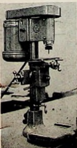
Die Firma Gebr. Saade brachte eine in einem Gerät vereinigte Präzisions-Dreh-, Fräs- und Bohrmaschine heraus
