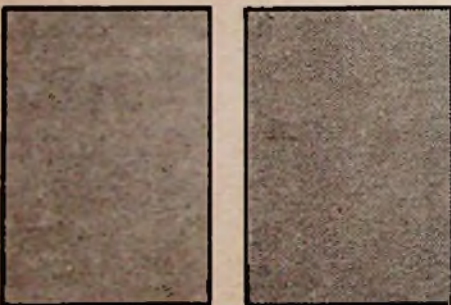
Abb. 1. Bildwiedergabe mit zwei verschiedenen Auflösungsgraden. Auf dem linken Bild kommen 48 und auf dem rechten 24 Rasterzeilen, d.h. 576 bzw. 144 Rasterpunkte auf den Quadratzeptimeter
