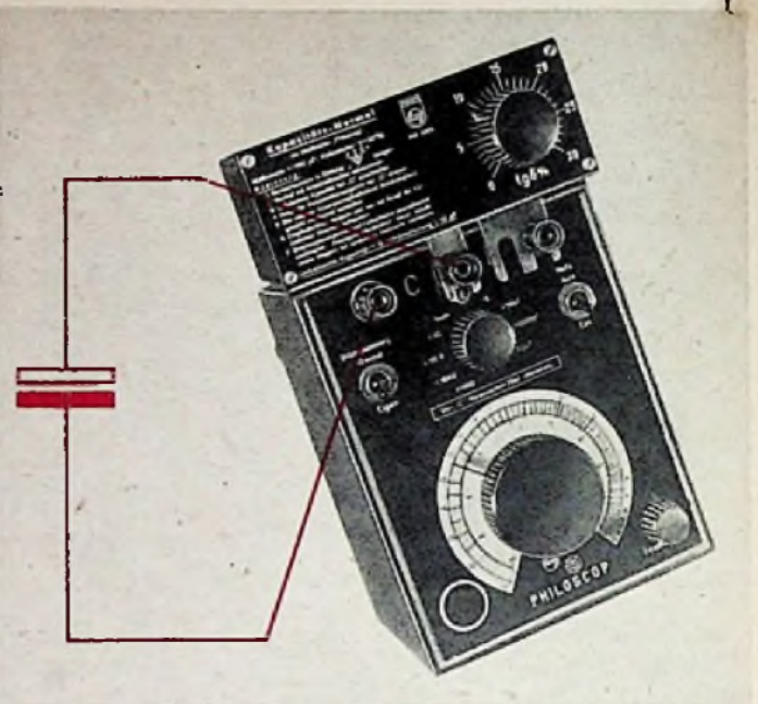
Philoscop-Meßbrücke mit angesetztem Kapazitätsnormal zur Messung des \text{tg } \delta -Wertes von Elkos
